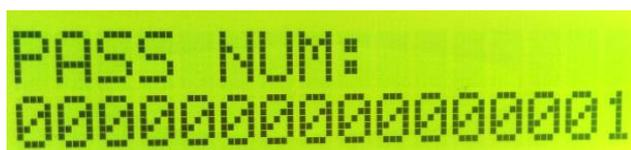
烧录成功一颗 IC，PASS NUM 加 1，达到最大设定值后，烧录器不再响应任何脱机烧录命令，显示器显示如下，此时需连接上位机更新 Pass Count 后方可继续脱机烧录。
