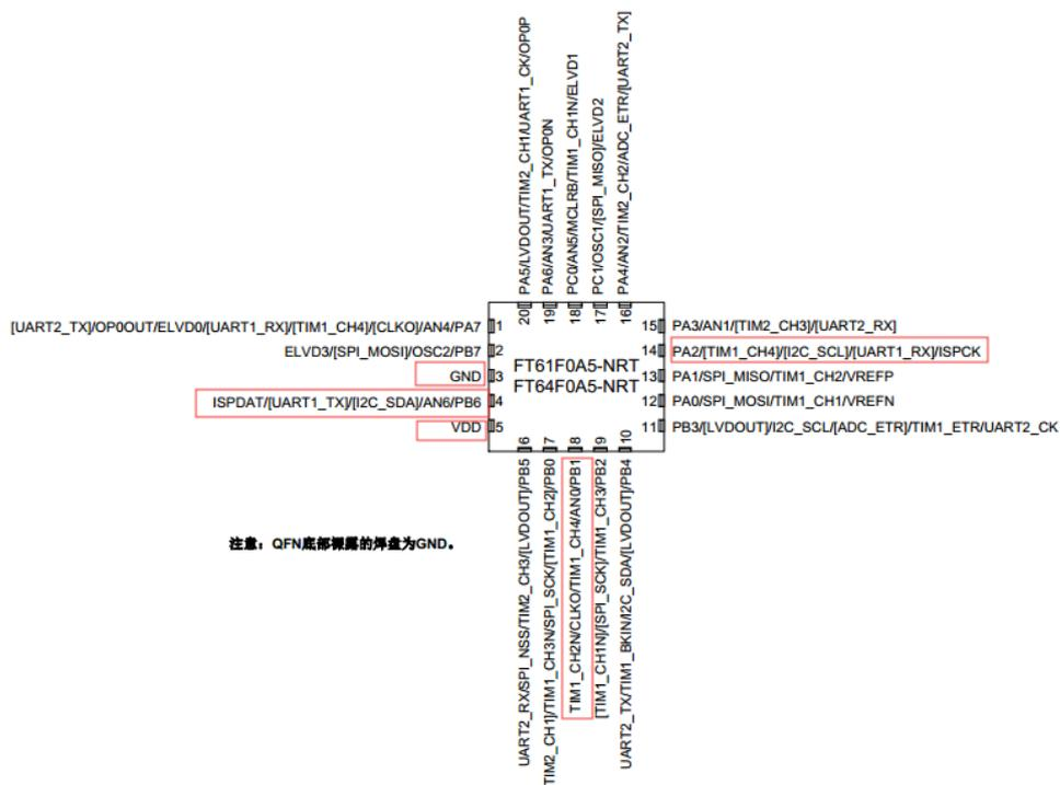
注意：QFN底部裸露的焊盘为GND。
