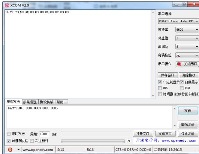
返回的数据 14 27 70 50 4E 00 03 00 01 00 02 00 03；后九位 4E 表示写入成功，00 03 表示读取的数据长度 C，00 01 00 02 00 03 表示所查询的数据。
